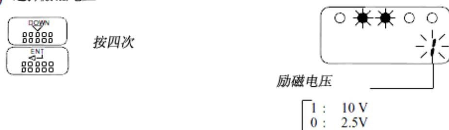
使用“UP”和“DOWN”键设定励磁电压，
